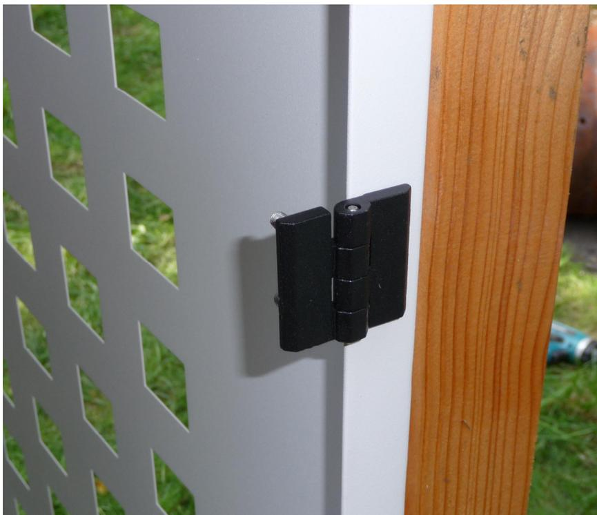
Die Scharniere aus schwarzem Alu Druckguss sind mit Gewindestangen versehen und lassen sich wie im Bild zu sehen ohne „Fummelei“ einfach aufstecken. Danach werden sie von der Innenseite der Box her mit selbst sichernder VA Mutter und Unterlegscheibe festgezogen.
